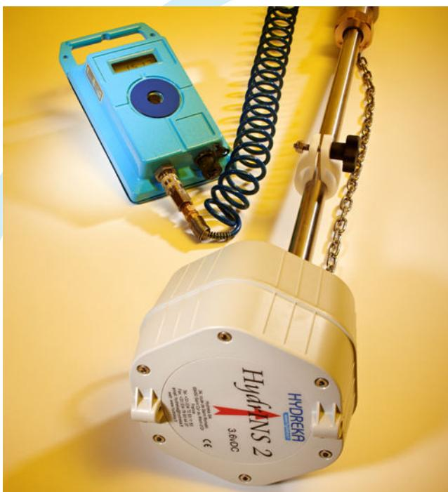
Il misuratore di portata elettromagnetico HydrINS 2 è stato progettato per misurare la velocità dell'acqua in condotte piene senza interrompere l'approvigionamento idrico. E' applicabile su qualsiasi tubazione con un diametro interno tra 100 e oltre 2000 mm.
